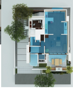
洪水対策も最近の大きなテーマ。「止水板」(写真左)で浸水を防ぎ、万が一浸水しても、室内に水が溜まらないように逃げ道をつくる提案も(写真上/水色部分)。(ミサワホーム)
